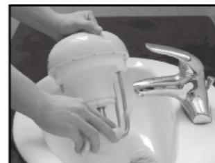
3. 电热器：请用清洁块清洗电热器，将电热器粘的豆浆膜或其它东西清洗干净，以免下次使用产生糊味。
